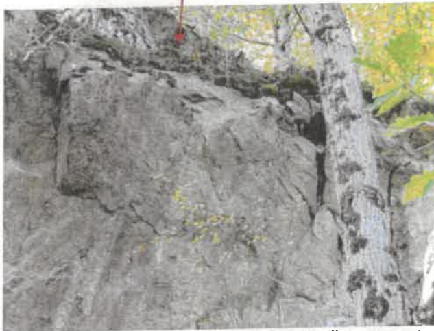
Potentialité d'instabilité d'environ 250 l en tête d'escarpement
